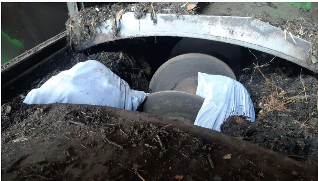
Obrázok 4.9: Vkladanie vriec so vzorkami do hnijúcich bubnov
